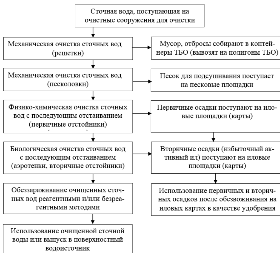
Рис.5.2. Схема очистки сточных вод
